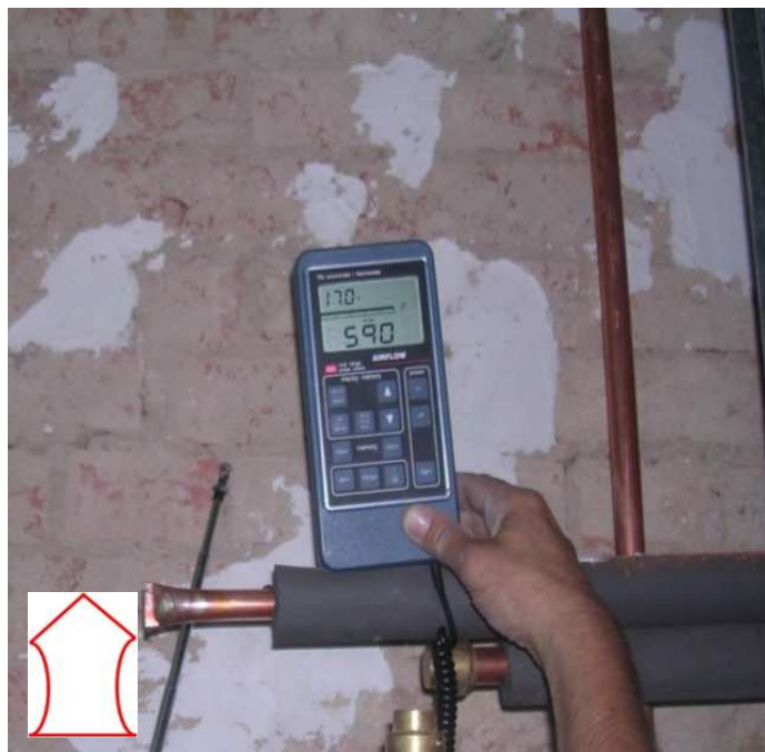
Monitoring během procesu výstavby: BlowerDoor test při podtlaku
