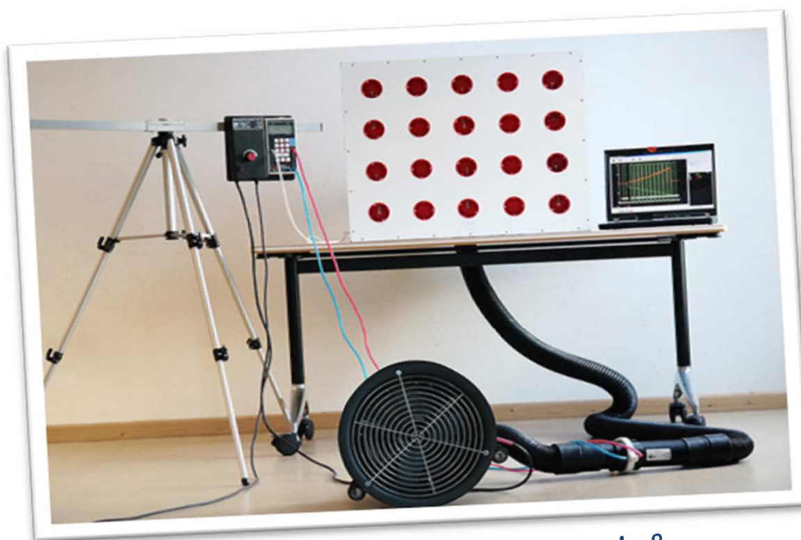
Testování stavebních prvků s mikroprůtokoměrem (MLM)
