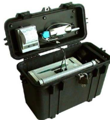
Zařízení pro měření radonu RTM 1688-2, výrobce Sarad, Drážďany, Německo
